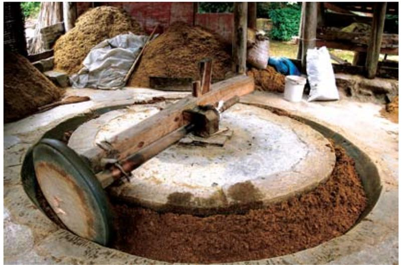
沉重的碾轮不停地有力地转动，它的动力来自于下方清彻的溪流，溪水不断推动旋转的浆轮。
